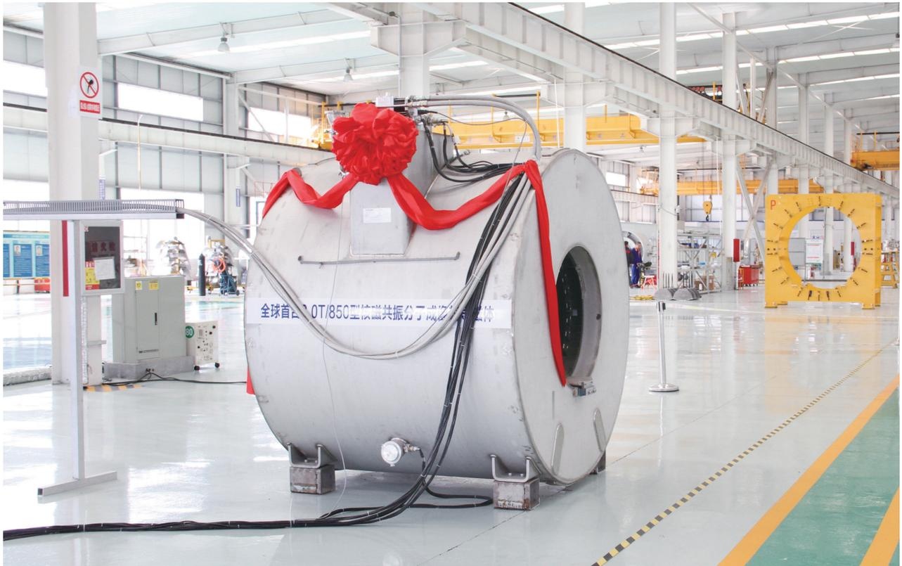
我公司设计开发的 3.0T 核磁共振成像超导磁体采用先进技术对超导磁体进行优化设计，磁场强度达到 3.0T，45cm 球区域内磁场均匀度达到  $< 2\text{ppm (vrms)}$ ，磁场稳定度  $< 0.05\text{ppm/h}$ 、实现液氮零挥发，各项指标均达到国际先进水平，属国内首创，打破国外技术垄断，为国内开发精准医疗领域成像新技术的 3.0T 核磁共振成像系统提供核心部件配套和必要条件。
